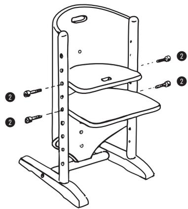
Das Sitzbrett wird am besten in die zweite Position von oben mit den Schrauben ② montiert.
