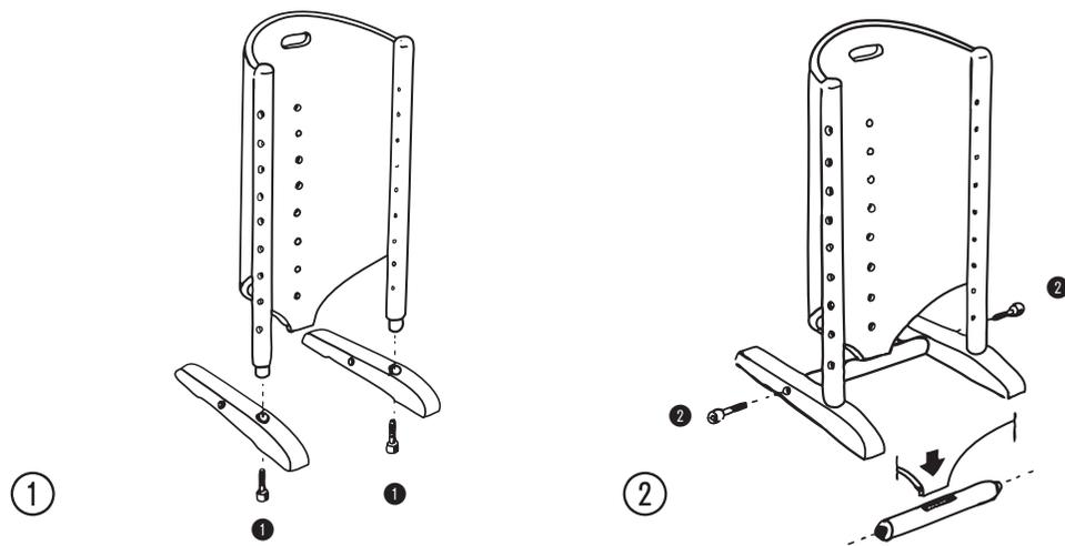
Die Schrauben ① und ② während der Montage von Punkt ① - ③ nur locker anziehen!
