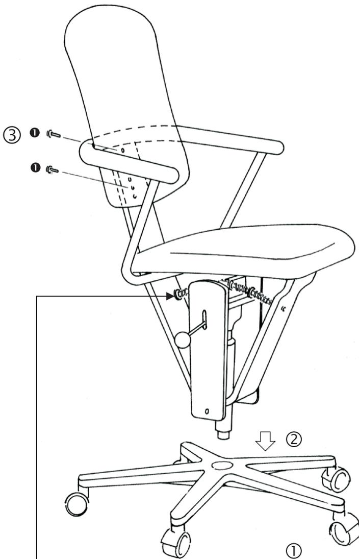
① Montieren Sie die Rollen an das Fußkreuz und stellen Sie das Fußgestell auf den Boden.
