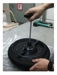
Nach der Einstellung den Sitz wieder auf die Gasdruckfeder aufsetzen und durch eine Sitzprobe die Auslösung testen.
