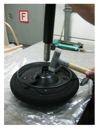
Die Gasdruckfeder festhalten und durch kurze, feste Schläge mit einem Kunststoffhammer (bei einem Metallhammer ein Tuch zwischenlegen) auf die Auslösemechanik die Verbindung zum Konus lösen.
